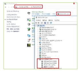
パソコンにセットされた、USB/シリアル 変換器に対応するCOM番号はコントロ ールパネル > ハードウェアとサウンド > デバイスマネージャーで参照できます。
